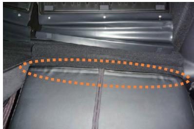
5 ○位置のラインに沿って、カバーをマジックテープでシートに直接固定します。
