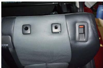
9 リクライニングスイッチ部の隙間にも生地を入れ込み、ヘッドレストの台座を取り出します。
