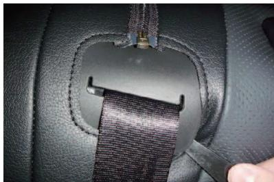
8 中央席用シートベルトの台座の隙間に生地を入れ込みます。
