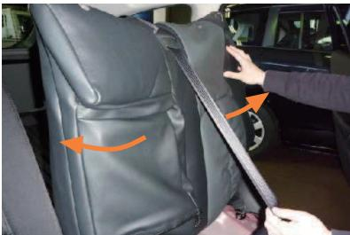
2 中央席用のシートベルトの下側を通して、背もたれを覆うようにカバーをかぶせます。
