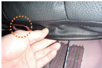
10 カバー前側に付いているマジックテープをシートに直接固定します。
