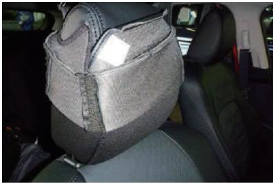
1 カバーを裏返してヘッドレストのラインに合わせてかぶせます。この際ヘッドレストの先端まで生地が張るように、しっかりとかぶせて下さい。
