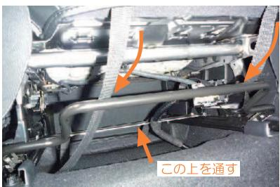
8 カバー前側に付いているベルトをシートの底面を通して、後ろ側へ引き出します。
