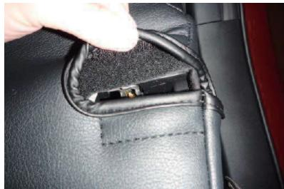
6 シート背面のヒンジ部をかわすように、カバーをマジックテープでシートに直接固定します。
