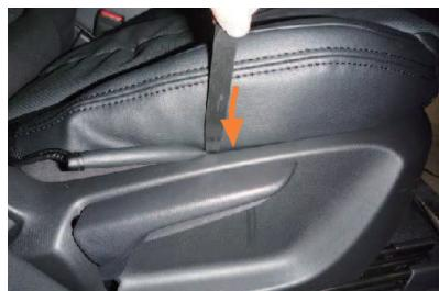
6 カバー外側面の生地を、シートとプラスチック部の隙間に入れ込みます。
