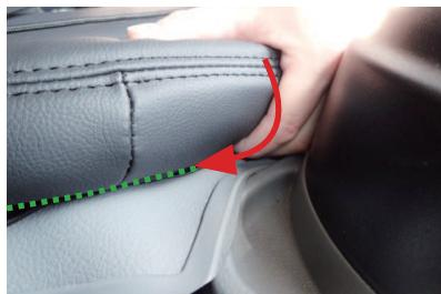
6 3番の点線部で示した位置には、カバーにヒモが付いています。ヒモが付いた生地をシートのフチに入れ込みます。（図はシート内側面）
