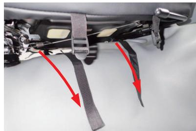
10 ③番で後ろ側へ引き出した生地に付いているベルトを、座面裏を通して前側から取り出します。
