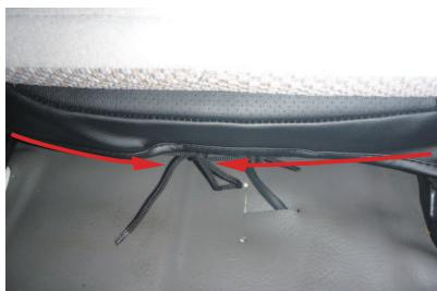
9 シート両側面から通したヒモを、シート後ろ側で結び留めます。
