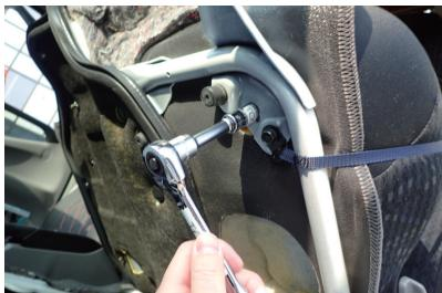
6 ソケットレンチ（12mm）などを使用しナットを外します。
