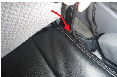
8 内側面の生地をシートの隙間に入れ込みます。生地に付いているヒモは、シートの後ろ側へ通します。
