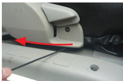
6 外側面の生地に付いているヒモは、シートの側面に沿わせながら、座面後ろに引き出します。
