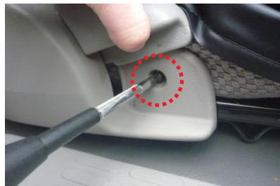
4 リクライニングレバーを上げた状態で見えるネジを、プラスドライバーを使用し、締めます。
