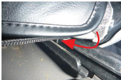
7 6番で引き出したヒモは、図のようにシートレールの隙間に引っ掛けるようにします。
