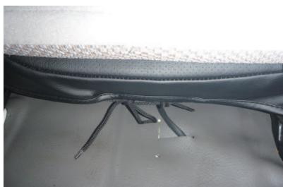
9 シートの後ろ側で、左右のヒモ同士を結び固定します。（結び方は17ページ参照）強く引っ張り過ぎると、ヒモが切れる恐れがありますのでご注意下さい。
