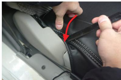
5 ヘラ等を使用し、外側面の生地をシートの隙間に入れ込み、4番で緩めたネジを締め直します。
