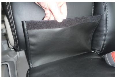
8 助手席座面カバーに付いている、マジックテープが付いた生地を、中央席背もたれカバー底部に付いているマジックテープに固定します。
