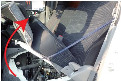
4 固定具を外し、エンジンフードを跳ね上げます。
