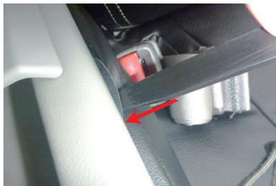
7 2番で外したトレーを元に戻し、トレーの隙間に生地を入れ込みます。
