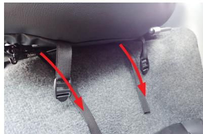
10 3番で後ろ側へ引き出した生地に付いているベルトを、座面裏を通して前側から取り出します。
