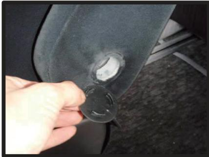
①背もたれカバーをかぶせる前にアームレストを外します。プラスチックのフタを外して中のボルトを外します。
