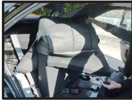
⑨側面のファスナーを開いた状態にして、カバーを半分程裏返してシートのラインに合わせてかぶせます。
