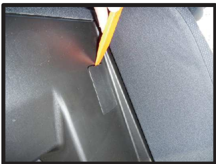
⑥助手席側は、運転席側の背もたれを倒すと見える、図のプラスチックカバーを、ヘラなどを使用して外します。
