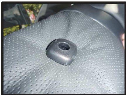
⑬ヘッドレストの台座をカバーの加工穴から取り出します。
