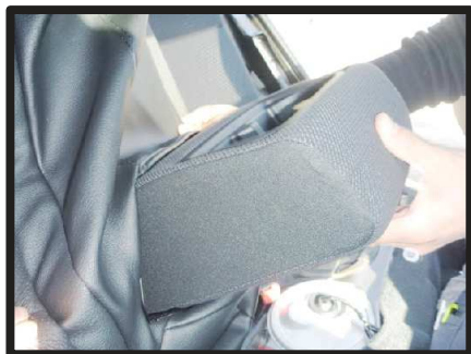
⑩カバーの加工穴からアームレストを取り出します。
