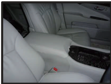
③カバーのラインを整えます。1列目アームレストの完成です。※生地が厚みがありますので、アームレストを閉じる際、後ろ側から押して固定して下さい。
