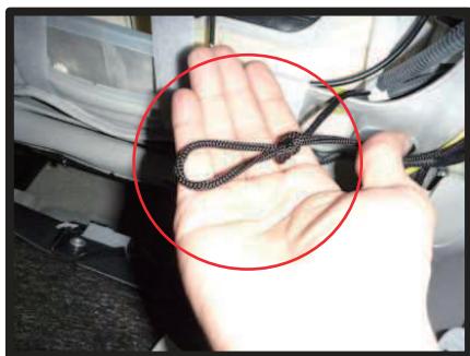
⑥ カバー両端に付いているヒモを後ろ側で固定します。 片側のヒモで輪を作り、反対側のヒモを通して絞り込み固定します。
