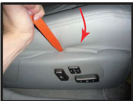
⑫シート本体とプラスチックカバーの間に生地を入れ込みます。
