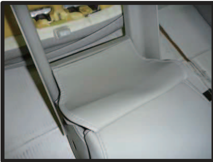
⑭ヒンジ側に付いている生地は純正生地の上に重ねて置きます。 ※固定はしません。
