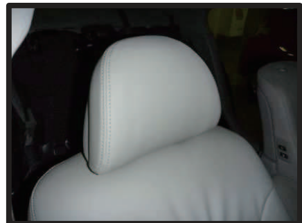
③シートに戻して、1 列目ヘッドレストの完成です。 固定用のピンを取り付け、バックボードに戻します。
