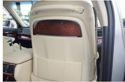
10 1P2Pで取り外したバッククリップとバックボードを元に戻します。
