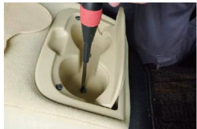
**12** アームレストのカップホルダーを取り外します。カップホルダーのフタを開け、底に敷いた生地をめくると、ネジがありますのでプラスドライバーで外します。
