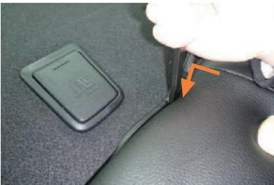
**9** シート上側と車体の隙間に生地を入れ込みます。
