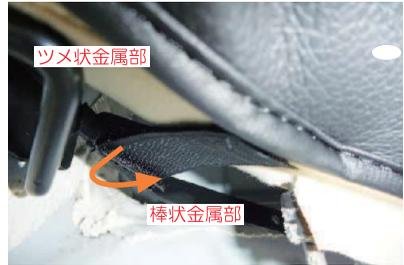
**11** シート下部のツメ状の金属部（座面取付け時に引っ掛ける、座面のツメが固定される場所）の横にある棒状の金属部に、カバーに付いているマジックテープベルトを巻き付け、固定します。
