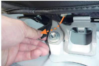
10 シート下部の図の位置に、カバーに付いているマジックテープベルトを巻き付け、固定します。
