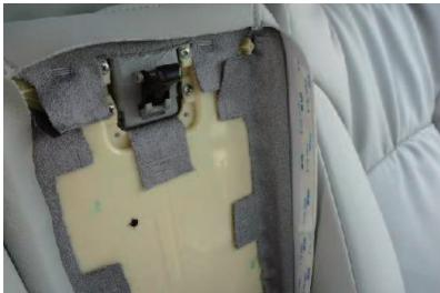
9 両面テープ等を使用して、フタの内側にカバーを巻き込み、仮留めした状態で、1番で取り外したプラスチック部を元に戻します。
