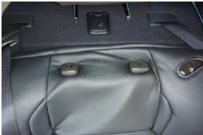
7 1列目と同様に、カバーの加工穴からヘッドレストの台座を取りだします。
