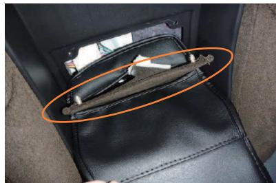
11 めくり上げた生地をカバーの加工穴を通してから、元に戻します。
