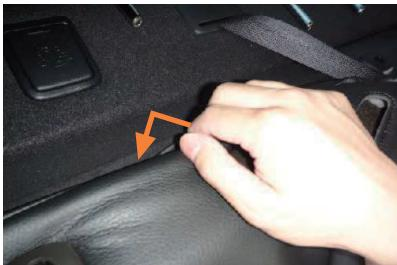
8 シート上側と車体の隙間に生地を入れ込みます。
