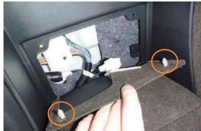
10 フタは、背もたれ側にも固定されていますので、図の2ヶ所のピンを引き抜き、生地をめくり上げます。
