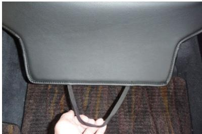
13 カバー背面に付いているゴムに、付属のS字フックを取り付け、シート底面に引っ掛け固定します。
