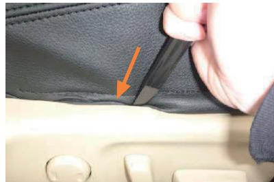
6 カバー外側面の生地を、シートとプラスチックパーツの隙間に入れ込みます。
