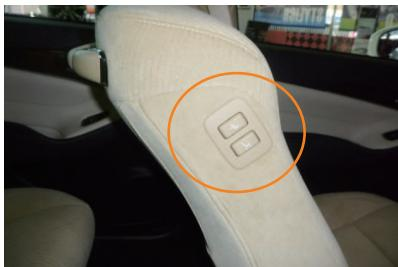
16 助手席背もたれ内側面には、パワーシート操作用のスイッチがあります。スイッチはカバーで覆われても使用出来ますが、カバーに穴開け加工する事でスイッチ部を取り出す事が出来ます。
