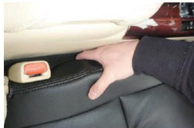
5 シートの内側面に付いているシートとコンソールの隙間を隔す生地の上から、カバーをマジックテープでシートに直接固定します。
