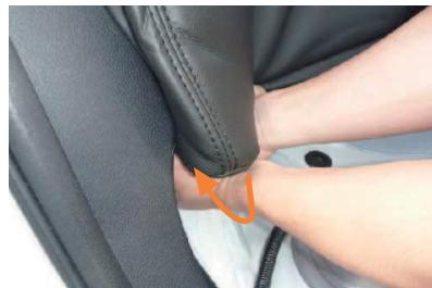
4 生地の伸びを利用して、シート下側の角にカバーを引っ掛けるようにかぶせます。
