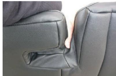
11 助手席側と中央席のシートベルトバックル収納部のラインに合わせ、カバーを整えます。
