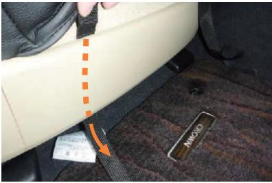
7 カバー前部に付いているベルトを、シートとプラスチックパーツの隙間を通します。
