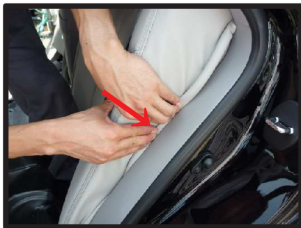
⑩側面の生地を車体とシートの間に入れ込みます。
