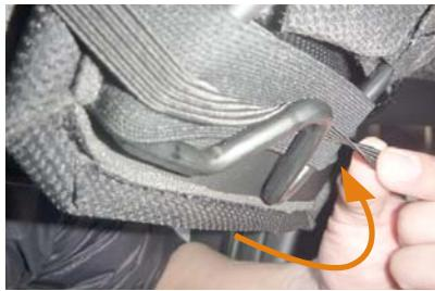
13 14ページ12番のゴムを、純正シート表皮の長方形型の生地を固定しているゴムと同じ位置に引っ掛けで固定します。図はシートの裏側からです。
