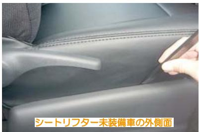
21 シートリフター未装備車のシート外側面はシートとプラスチック部の隙間に端に固定部材の付いた生地を入れ込みます。
