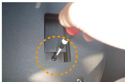
17 シート背面のスライドレバーを固定しているネジを、ドライバーを使用して外します。
