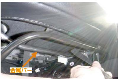
14 カバー前側に付いているベルトを、図のシート裏にある金属バーの上を通して、シート背面へ入れ込みます。
