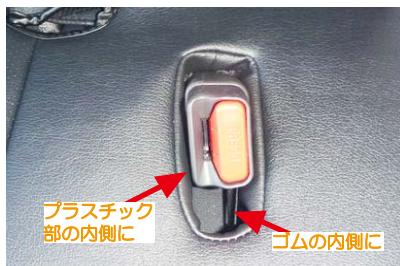
23 22番の切れ込み部分で収納部内側のプラスチック部とバックルを固定している純正ゴムをかわして生地を入れ込みます。
