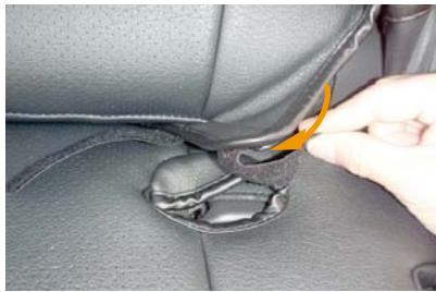
8 シート内側の軸付近に、マジックテープが2本付いています。マジックテープもねじれないように背もたれと座面の隙間に入れ込みます。
