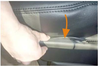
13 シートの内側面です。シートとプラスチック部の隙間に、端に固定部材の付いた生地を入れ込みます。
