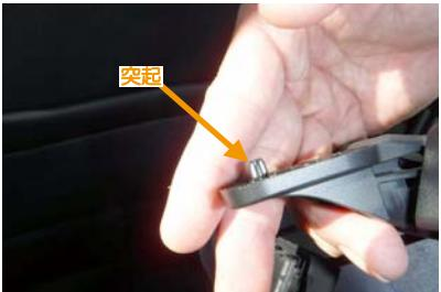
20 シートバックテーブルを固定している両端のプラスチックパーツの裏には、図のように突起している部分があります。この突起している部分が入る穴が両端にあるのでその部分の穴もあけます。
