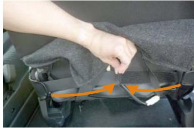
18 カバー両側面の後ろ側から出ているマジックテープを、シートの背面側から引き寄せ合い固定します。この際、5ページ1番で外した生地をめくり上げて、生地の内側でマジックテープを固定するようにして下さい。
