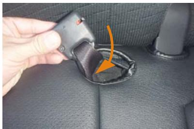
21 通したゴムはバックルの付け根まで入れ込みます。バックルを収納し直すと、カバーの生地が浮かないように押さえられます。
