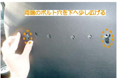
21 両端に開けた穴を下に少し広げると、図の突起部分が収まる穴が見えます。
