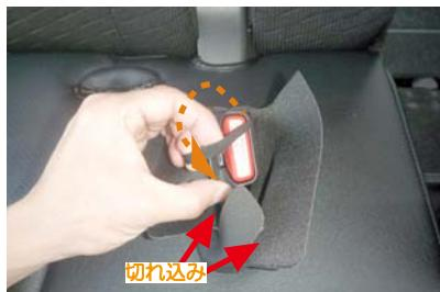
22 もう一つのシートベルトバックル収納部です。こちらもカバーに付いているゴムをバックルに通します。収納部に入れ込む生地には図のように2か所の切れ込みがあります。
