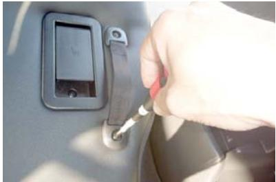
19 始めに外したベルトを元通りに固定します。
