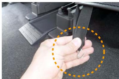
15 カバー背面下に付いているゴムに、付属の金属フックを取り付けます。
