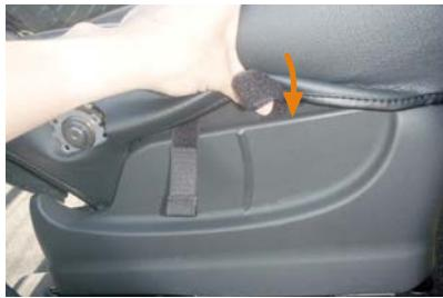
11 カバー外側面に付いている2本のマジックテープのベルトを、シートとプラスチック部の隙間に入れ込みます。
