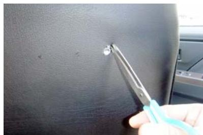
18 穴位置にまずは印を付けて、印の位置をハサミなどで切れます。ボルトの頭部分の程の大きさを開けて下さい。この際シート地を傷付けないように、作業は慎重に行って下さい。
