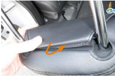
4 ヘッドレストをシートから外します。ヘッドレスト裏でプラフックを固定します。
