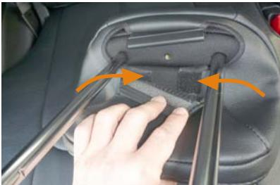
10 カバーをヘッドレスト全体にかぶせたら、ヘッドレストをシートから外します。ヘッドレスト裏で生地を内へ寄せながらマジックテープを固定します。
