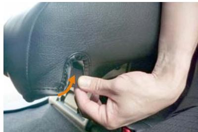
18 シート内側です。シート内側のカバーの裏側にはマジックテープが付いています。マジックテープを直接シートの裏側に貼り付けて固定します。
