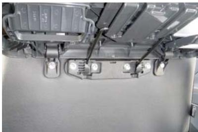
22 シートバックテーブルを元通りに固定します。ボルトを強く締めすぎるとプラスチックパーツが割れてしまうので、慎重に作業を行って下さい。
