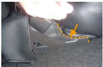
27 シートベルトバックルのある内側のプラスチック部とシートの隙間に生地を入れ込みます。隙間がかなり狭い部分もあります。ヘラなどを使用して慎重に入れ込んで下さい。
