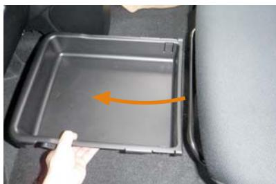
23 助手席側のシートアンダートレー装備車はトレーを引き出してカバーの装着を行います。
