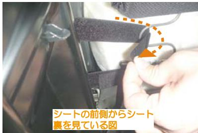
12 シート前側のシート裏から、入れこんだマジックテープのベルトを引き出します。ベルトはシート裏の金属部分に巻き付けて折り返し、先端がオスになっているマジックテープをメス側に貼り付けて固定します。
