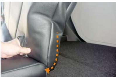
3 カバーをかぶせます。運転席側は座面同様にシート内側の下からカバーを引っ掛けるようにかぶせます。かぶせたカバーは生地にたるみが出ないように整えます。
