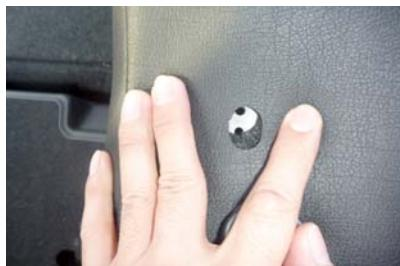
16 始めに外したベルトのネジ穴の位置と、カバーの加工穴の位置がずれていないかを確認します。装着が少しでもずれていると穴位置が一部だけずれてきたりする場合があります。全ての穴位置が合うようにカバーのラインを整えます。
