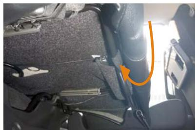
17 フックを固定すると図のようになります。カバー外側より生地に厚みがあるので、フックはしっかりと固定して下さい。
