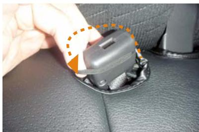
20 中央のシートベルトバックル収納部のカバーの裏側に、ゴムが付いています。ゴムをバックルに通します。
