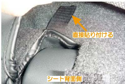
10 9番で入れ込んだ生地をシート背面の軸部分から引き出して、マジックテープを直接シートに貼り付けて固定します。
