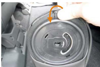
2 大きい加工穴の方から矢印の方向へ生地を引っ掛けるようにして、アームレスト全体にカバーをかぶせます。
