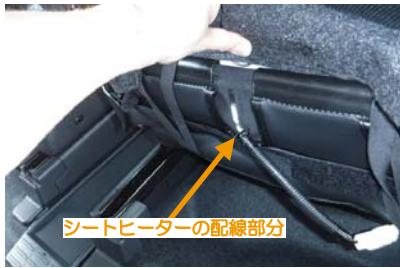
13 12ページ9番で引き出した生地に付いているフックを、図のようにシート背面裏のフチに引っ掛けで固定します。5ページ1番で外した生地をめぐり上げて作業を行って下さい。※ゴムが完全に外れてはいないので、引っ張りすぎにはご注意下さい。
