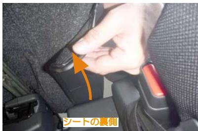
19 13ページ1番でシート内側に引っ掛けで固定したカバーを、シートの裏から引き出します。引き出した生地に付いているマジックテープを、直接シートに貼り付けて固定します。
