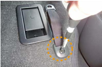
1 始めにシートを格納する際に使用するシート背面のベルトを、ドライバーを使用してすべて外します。
