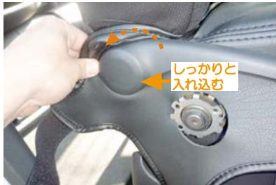
7 加工穴は小さめに開けているので、レバーの手前のフチに生地をしっかりと入れ込み、それから全体を通すようにして下さい。大きい方の加工穴をシートリフターの軸部分に合わせます。
