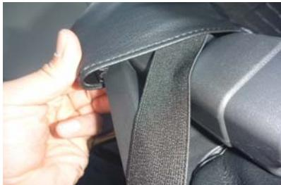
28 シートベルトバックルの付け根部分を覆っている生地の上から、カバーをかぶせます。こちらもシート内側と同様にフックで固定します。フックは前後2か所に付いています。
