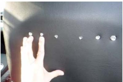
19 6本とも穴開けを済ました図です。図ではボルトのみシートに戻した状態にしています。
