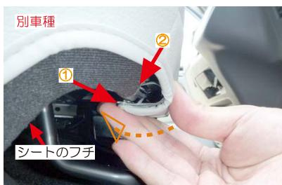
9 8番の①を先頭にフチに引っ掛けていきます。オレンジの矢印のようにフックの向きを回転させながら固定していきます。
