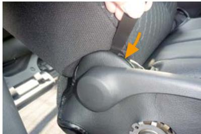
10 シートの軸部分に、ヘラなどを使用して生地を引っ掛けるように入れ込みます。内側も同様に入れ込みます。
