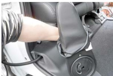
1 カバーを大きい加工穴の方から図のように裏返して、アームレストのラインに合わせてかぶせます。アームレストの先端までしっかりととかぶせて下さい。
