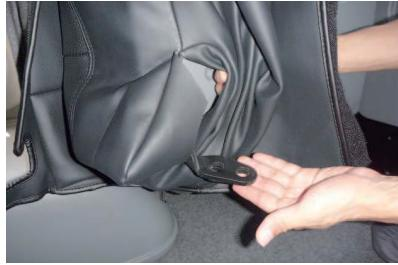
4 シートを跳ね上げて2番で外したステーをカバーの加工穴から取り出します。
