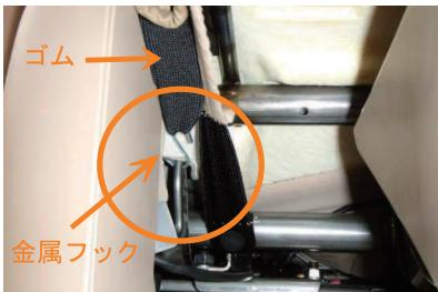
8 図は7番の部分を前側下から見た状態です。○の部分の金属棒に金属フックを引っ掛けで固定します。
