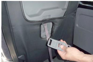
6 カバーの加工穴から跳ね上げ時にシートを固定するベルトを取り出します。
