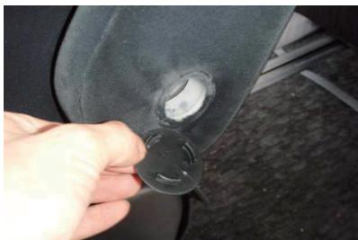
1 背もたれカバーをかぶせる前にアームレストを外します。プラスチックのフタを外して中のボルトを外します。（14mm）
