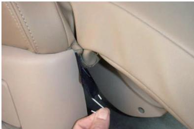
7 オットマンの根元部分に付いているゴムに付属の金属フックを取り付けます。
