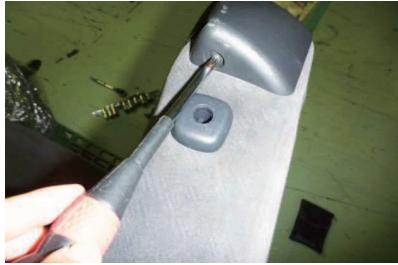
1 シートベルトガイド側面部のネジをドライバーで外します。
