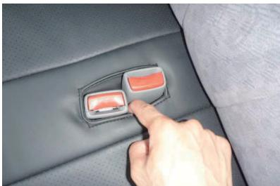
14 シートベルトのバックルが出ている穴のフチに生地を入れ込みます。
