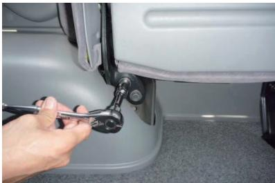
1 シートを跳ね上げた状態で、シート前側のステーを外します。2本のボルトで固定されているのでソケットレンチ等を使用してボルトを外します。（14mm）
