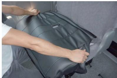
3 座面を倒した状態でカバーを半分ほど裏返して、シート前側に引っ掛けるようにかぶせます。
