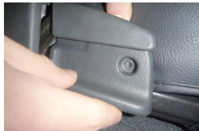
10 プラスチックパーツを浮かせて隙間から生地を入れ込み、カバーの加工穴の位置を突起部に合わせてネジを元通りに締めます。
