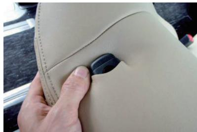
5 1列目と同様にしてヘッドレストの台座をカバーの加工穴から取り出します。
