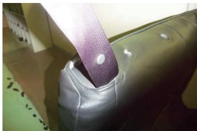
3 カバー背面のファスナーを開き、シートベルトをかわした状態でカバーをシートにかぶせます。
