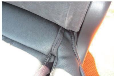
7 カバーの加工穴部分のファスナーを開き、シートベルトを通してから再びファスナーを閉じます。
