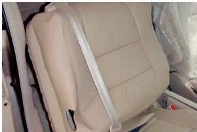
2 カバーのファスナーを開いた状態でシートのラインからずれないようにカバーを全体にかぶせます。シートベルトとシートの間にカバーをくぐらせるようにします。
