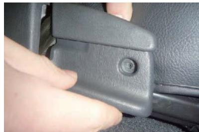
10 プラスチックパーツを浮かせて隙間から生地を入れ込み、カバーの加工穴の位置を突起部に合わせてネジを元通り締めます。
