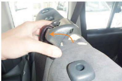
2 シートベルトガイドを矢印の方向に持ち上げて外します。
