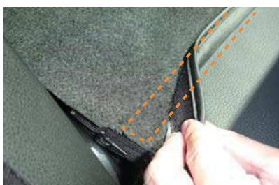
11 カバー背面下部の生地裏に付いているマジックテープを、シートに直接貼り付けて固定します。
