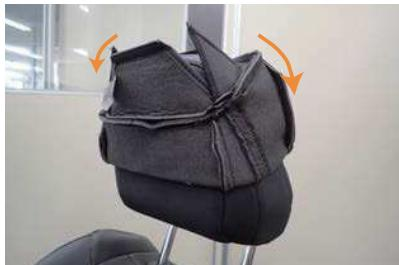
1 カバーを半分程度裏返し、ヘッドラストの先端までしっかりとカバーをかぶせます。
