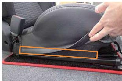
7 内側面の生地裏に付いているマジックテープをシートに直接貼り付けて固定します。
