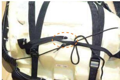
10 7番で通したゴムに付属の金属フックを取り付け、シート底面に引っ掛け固定します。
