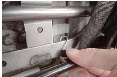
**16** 生地をシート裏に回し、ゴムに取り付けた金属フックをシート裏の金属部分に固定します。
