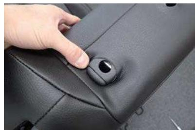
12 生地の伸びを利用して、カバーの加工穴からヘッドレストの台座を取り出します。
