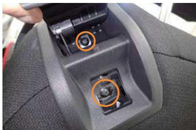
2 図のように、レバーを上げた奥に1箇所と手前に1箇所でレバーがネジ止めされています。
