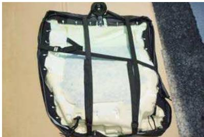
9 シートを裏返し、カバーに付いているベルトを固定します。5番で外したカブラー近くのベルトは少し緩めた状態にして下さい。※カブラーを戻す際、ベルトを強く固定していると戻しにくくなります。
