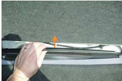
10 7番で入れ込んだ生地を背面側から引き出し、生地に付いているカギ状のブラフックと4番で外したブラフックの内、板状のブラフックを固定します（カギ状のブラフックはどこにも固定せずに、カバーの内側にある状態になります。）。
