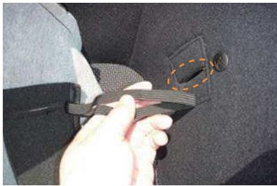
7 カバー裏面に付いているゴムを、チャイルドシート固定用フックの穴に通します。
