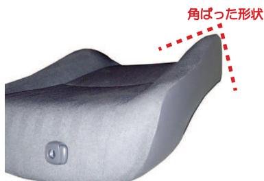
2 シートを上から見た状態です。通常、サイドエアバッグ展開部分はシート表面と側面の境界に位置し、一般的には角ばった形状をしています。サイドエアバッグ展開部分はその角の頂点に位置します。
