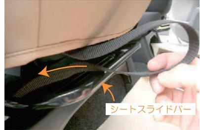
**10** カバー前側にあるベルトは、シートスライドバーをかわしてシートの後ろ側へ出します。
