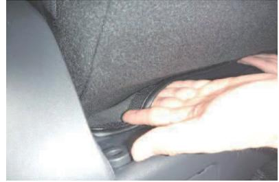
**10** 引き出した生地をマジックテープでシートに直接固定します。ベルトは生地を引き出す為の物ですので生地裏側へ仕舞い込みます。
