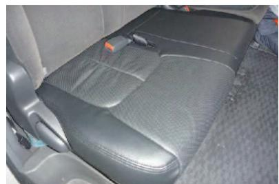
**12** カバーのラインを整えて2列目運転席側座面の完成です。多少形状は異なりますが助手席側も同様に取り付けます。
