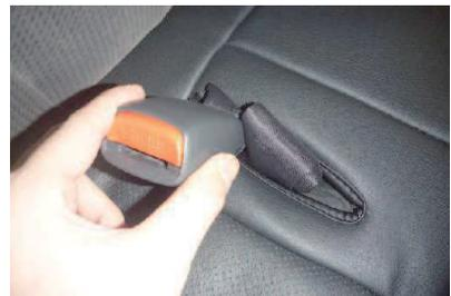
**11** カバーの加工穴からシートベルトバックルを取り出します。
