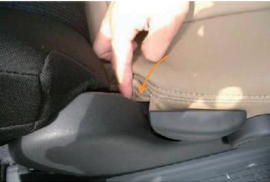
**8** 矢印部分の生地を図のようにシートの間隙へ入れ込みます。
