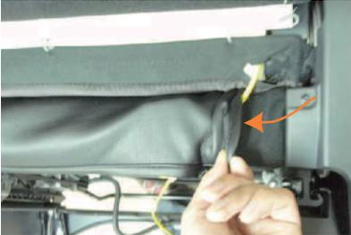
**7** 入れ込んだ生地を引き出す際、サイドエアバッグ装着車はサイドエアバッグ用の配線を切らないように生地を内側へよけながら引き出します。
