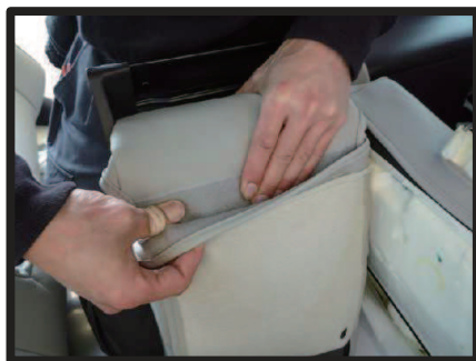
⑰アームレスト全体にカバーをかぶせたらマジックテープで固定します。
