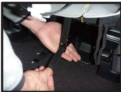
⑪1ページの⑥で入れ込んだ生地についているバックルに、⑦で引き出したベルトを固定します。
