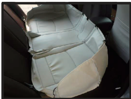
④カバーを裏返してシートラインに合わせて合わせます。
