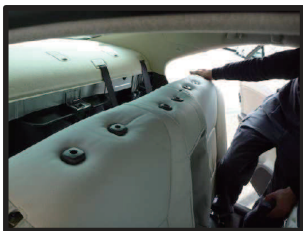
⑫ヘッドレストの台座を全て取り出します。
