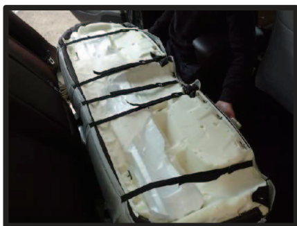
⑥シートを裏返してカバー前後のベルトを固定します。
