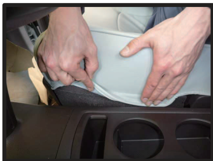
⑧シート内側側面にマジックテープが付いていますので、シートに直接固定します。
