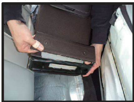
⑮アームレストにカバーを取り付けます。ナットが留まっていた部分の生地を軸から外します。
