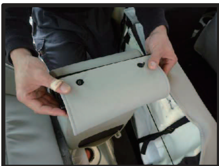
㉑ナットを留める軸にカバーの加工穴を通します。
