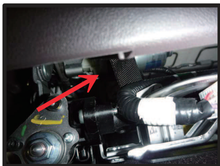
⑦シート裏の図です。取り出したベルトはシート裏にある金属部品の上を通して、背面から引き出します。
