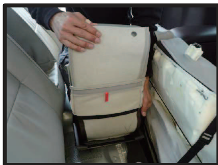
⑭⑮の生地を折り返してカバーの中へ収納するようにカバーをかぶせていきます。
