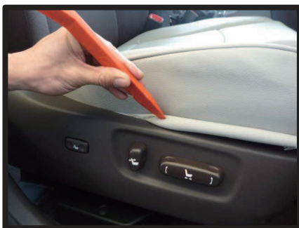
⑩シート外側の生地もヘラ等を使用して、シートとプラスチック部の隙間に入れ込みます。
