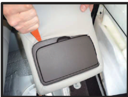
⑲ドリンクホルダーのフチに生地を入れ込みます。ヘラ等を使用すると作業が行いやすくなります。
