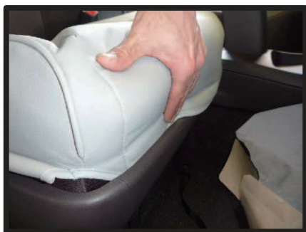
⑨シート前側の生地を、シートとプラスチック部の隙間に入れ込みます。
