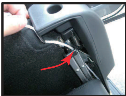
⑤ヒモは、座面の裏側まで引っ張ります。矢印のシートレールの上を通るようにして下さい。
