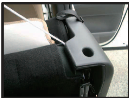
⑥座面の裏側の、プラスチックカバーの角の辺りにヒモが引っ掛かるようにします。 反対側のヒモも同様に通します。
