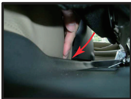
③運転席側カバーの側面の生地は、中央席との隙間のプラスチックカバーの中に入れ込みます。
