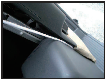
④シートを跳ね上げ、カバー側面のヒモを、シートのプラスチックカバーに沿って引き絞ります。 ※強く引っ張ると切れるおそれがありますので注意して下さい。
