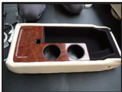
⑪ プラスチックパーツをボックスに戻します。この際、前側のツメから引っ掛けるようにします。
