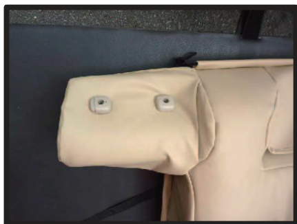
⑫アームレスト上部のヘッドレストの台座も取り出します。
