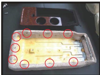
⑧ ボックスとプラスチックパーツは、ネジとツメで固定されています。図の赤丸部（9箇所）にツメがあります。
