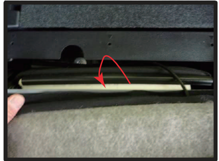
②①部分をめくるとシートの表面と背面の生地がプラスチックのフックで固定されています。カギ状のプラスチックに、はまっている板状のプラスチックを矢印の方向へ外します。シート表皮の固定が外れた状態からカバーの取り付けを始めます。
