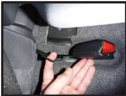
②運転席側背もたれは、シートに付いているゴムにシートベルトバックルが固定されています。バックルをゴムから外します。 ※助手席側は無し
