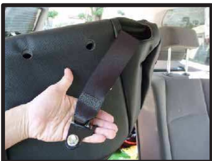
③カバーの加工穴から①で外したベルトを通します。
