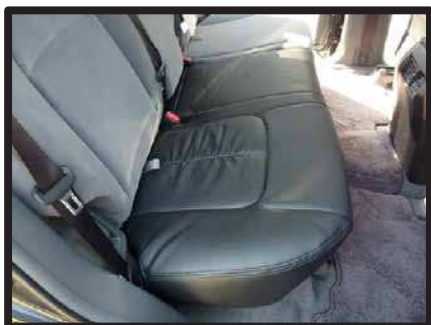
⑧カバーのラインを整えて2列目運転席側座面の完成です。 助手席側は一部形状が異なりますが同様の固定方法で取り付けを行います。
