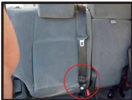
①丸印で囲んだシートベルトの付け根部分をラチェットレンチ等を使用して外します。
