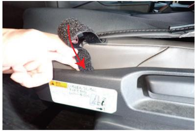
7 シートを一番前にスライドさせた状態で、カバー外側面の生地に付いているマジックテープベルトを、シートの隙間に入れ込みます。
