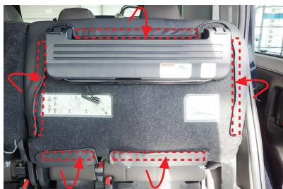
8 図のように、カバーに付いているマジックテープ（図の□部）をシートに直接貼り付け、固定します。マジックテープには保護テープが付いていますので、外してから作業して下さい。
