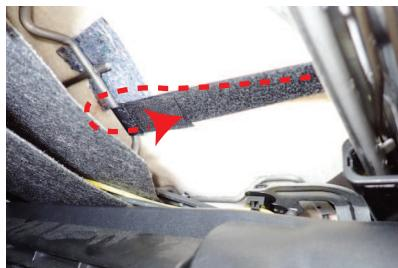
11 8番で引き出したマジックテープベルトをシート下の金属部分に巻き付け、ベルトを固定します。
