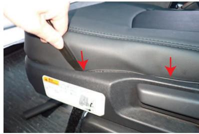
10 カバー外側面の生地をシートの隙間に入れ込みます。
