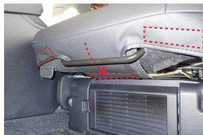
17 カバー前側に付いているマジックテープをシートに直接貼り付け固定します。中央部の生地は、図のようにシートスライドレバーの上側を通します。
