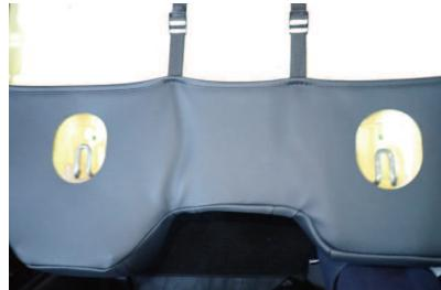
16 背もたれ背面のツメ位置に、カバーの加工穴が合っている事を確認して下さい。
