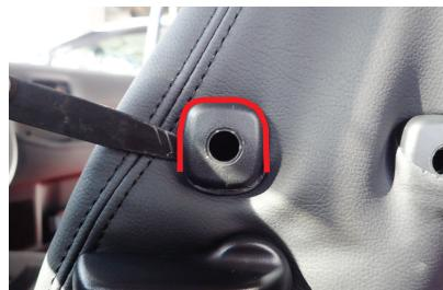
11 1番で取り外した料金トレイの台座を、カバーの加工穴から取り出します。図の赤線部分の隙間に生地を入れ込みます。
