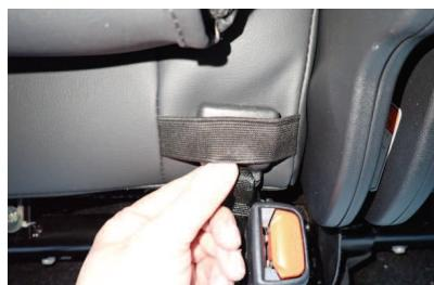
18 **2番**で取り外したシートベルトバックルをカバーに付いているゴムバンドに通し、固定します。
