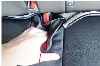
5 シートベルトバックル部の隙間に生地を入れ込みます。
