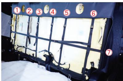
15 カバー背面の7本（上下6本・左右1本）のベルトを固定します。
