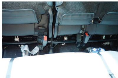
17 取り外した逆の手順で、背もたれを車体に戻し、**6番**で外したボルトを固定します。
