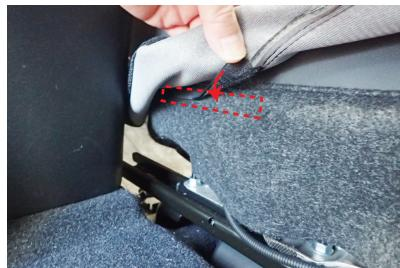
10 カバー内側面の生地に付いているマジックテープをシートに直接貼り付け、固定します。マジックテープには保護テープが付いていますので、外してから作業して下さい。始めに、図で示した位置に付いているマジックテープを固定します。
