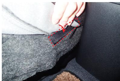
12 カバー内側面の生地に付いているマジックテープをシートに直接貼り付け、固定します。マジックテープには保護テープが付いていますので、外してから作業して下さい。始めに、図で示した位置に付いているマジックテープを固定します。
