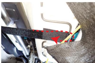
8 6番で引き出したマジックテープベルトをシート下の金属部分に巻き付け、ベルトを固定します。
