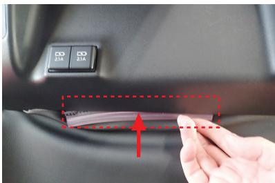
8 始めに、下側の生地に付いている固定用部材を、シートバックアシストボードの隙間に入れ込みます。
