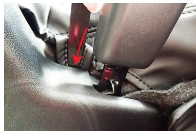
16 シートベルトバックル部の隙間に、生地を入れ込みます。
