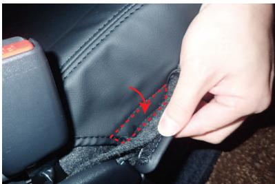
15 図のように、シートベルトバックル収納部の生地を広げた状態で、生地に付いているマジックテープをシートに直接貼り付け、固定します。
