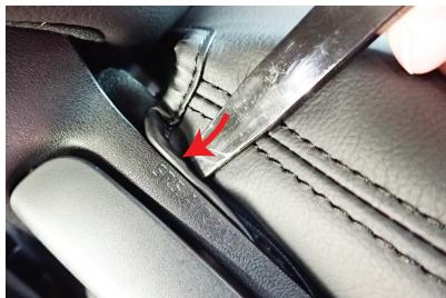
9 リクライニングレバー横の生地は、下方向には入り込まないので、図のようにシートに沿って、外側方向に生地を入れ込むようにします。
