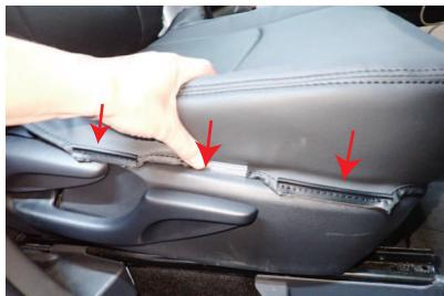
7 カバー外側面の生地をシートの隙間に入れ込みます。
