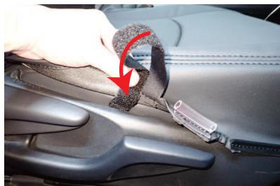
5 カバー外側面の生地に付いているマジックテープベルトを、シートの隙間に入れ込みます。
