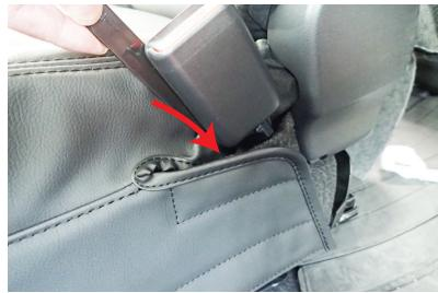
12 シートベルトバックル部の隙間に、生地を入れ込みます。
