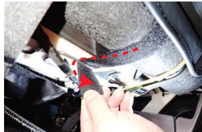
16 マジックテープベルトを、シート下の金属部分に巻き付け、ベルトを固定します。
