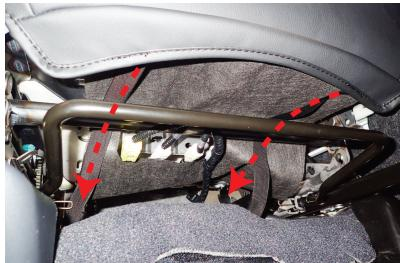
13 カバー前側の生地に付いているベルトを、座面裏を通して後ろ側から引き出します。ベルトは図のように、シートスライドレバーの上側を通すようにして下さい。ベルトは、**4番**で引き出した生地に付いているバックルに通し、固定します。
