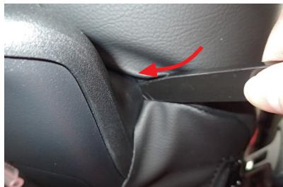
4 シートバックアシストボードの隙間に、ヘラ等を使用し、生地を入れ込みます。
