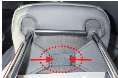
10 ヘッドレストを台座から取り外し、カバー底面のマジックテープ同士を固定します。
