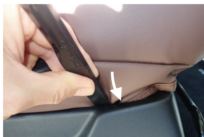
20 一番上に調整していたシートを下げると、 生地がプラスチックパーツの間からはみ出てくる ことがあります。その場合はヘラなどで生地を 入れ込み、整えてください。
