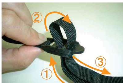
18 ベルトの通し方は、図の①～③の順番に ベルトをバックルに通し、引く事でベルトが 締め固定されます。 ベルトを強く引き過ぎると、生地が破れたり、 ベルトが切れる恐れがありますので、 注意してください。
