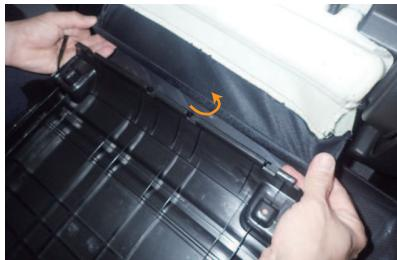
6 端から順にフックを外していくようにすると、図のように純正表皮が外れます。
