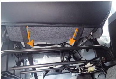
13 カバー前側に付いているベルトを、シート下側を通し、後ろ側へ引き出します。この際、図のようにシート下の金属部の上側を通すようにしてください。通したベルトは、③番で引き出した生地に付いているバックルに通し、固定します。
