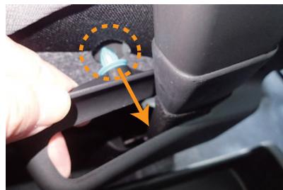
9 シート内側面のシートベルトバックル位置にあるプラスチックパーツの固定を外します。プラスチックパーツは、図のように固定具を真横に引き抜くようにすると外す事が出来ます。固定具のみを外し、プラスチックパーツに浮きが出来る状態にします。プラスチックパーツを外してしまう必要はありません。
