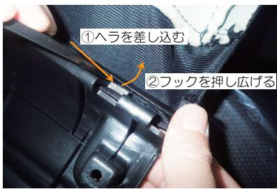
5 バックテーブルと純正表皮は、純正表皮に付いているフック状のプラスチックパーツが、バックボードの溝と突起部（7番を参照）に引っ掛かり、固定されています。ヘラ等の先の細い工具を、①バックテーブルの突起部に差し込みながら、②フックを押し広げるようにします。この状態で純正表皮とバックボードをすらすようにすると固定が外れます。
