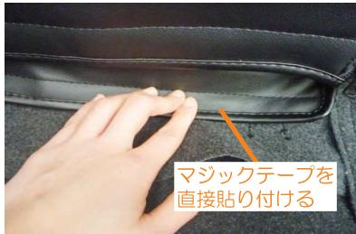
10 引き出した生地の先端にはマジックテープが付いています。このマジックテープを直接シートに貼り付けて固定します。
