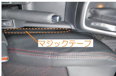
10 内側面も同様にマジックテープをシートに直接貼り付け固定します。
