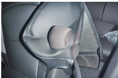
2 アームレスト付き車はカバーの側面に加工穴が開いています。
