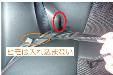
13 カバー両側面の生地をシートと車体の隙間に入れ込みます。側面の生地にはヒモが付いているので、そのヒモは入れ込まないよう注意して下さい。
