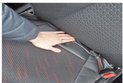
3 カバー奥の生地を背もたれと座面の隙間に入れ込みます。
