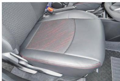
12 カバーのラインを整えて、1列目運転席座面の完成です。助手席も一部形状が異なりますが同様に取り付けます。
