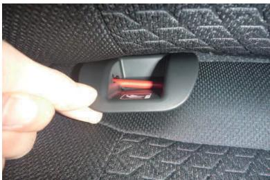
1 カバーを取り付ける前に、チャイルドシート用アンカーのプラスチックカバーを外します。プラスチックカバーはアンカーにはめ込まれている為、奥から手前に引くよう取り外します。
