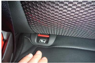
20 チャイルドシート用アンカーのプラスチックカバーを戻します。取り外した時と逆の手順でアンカー部分にしっかりとめ込んで下さい。
