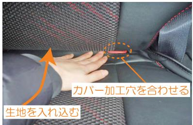
7 カバー奥の加工穴（左右2ヶ所ずつ）をチャイルドシート用アンカーに合わせ、背もたれと座面の隙間に生地を入れ込みます。
