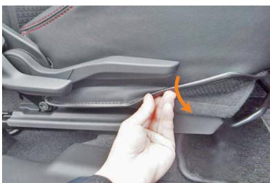
9 カバー側面のマジックテープをシートに直接貼り付けて固定します。
