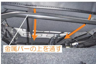
5 カバー前側に付いているベルトをシートの背面へ通します。この際、金属のバーが手前にあるのでその上にベルトを通して下さい。運転席座面にはシートヒーターの配線があるので、ベルトが干渉しない様に気を付けて作業を行って下さい。
