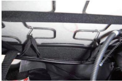
13 8P 12番で取り付けた金属フックをシート裏の金属部に引っ掛けて固定します。
