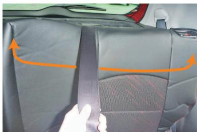
2 シートベルトをかわしながら、シートのラインに合わせて、カバーを全体にかぶせます。カバーのヘッドレスト用加工穴をヘッドレスト台座の穴位置に合わせるようにかぶせます。
