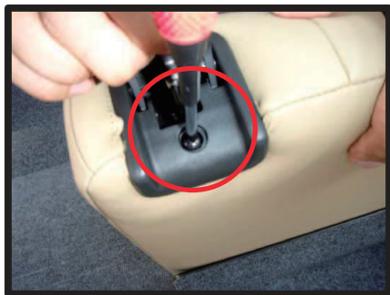
⑧リクライニングレバーの下にあるネジを緩めます。 シートとプラスチックパーツの間に生地を入れ込み、ネジを締めます。
