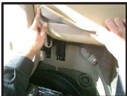
⑨引き出したカバー部分に付いているマジックテープを、背もたれ後ろに付いているマジックテープ部分に固定します。
