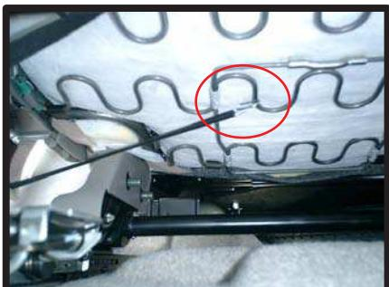
⑥金属フックを取り付けたゴムを座面シートの裏に伸ばして、写真のように引っ掛けます。
