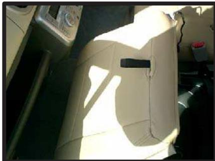
③助手席座面を引き上げる際に使用するベルトを、シートカバー中央上部の穴から出します。
