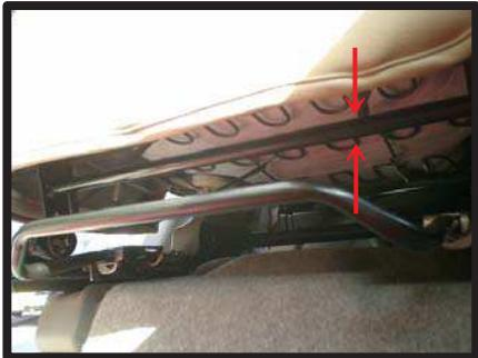
⑦カバー前方のベルトは、座面下の矢印が指している金属バーの上を通して後ろ側から引き出し、④で引き出した生地に付いているバックルに固定します。
