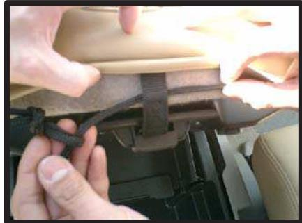
④カバーを固定するヒモを座面下側のベルトの内側を通して、運転席座面と同じように結びます。
