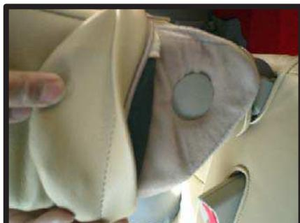
⑤シート本体に取り付け後、カバーをかぶせる前にキャップを付けます。
