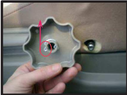
①初めにシートリフターのハンドルを取り外します。○の中の金具を矢印の方向へ押すと外れます。
