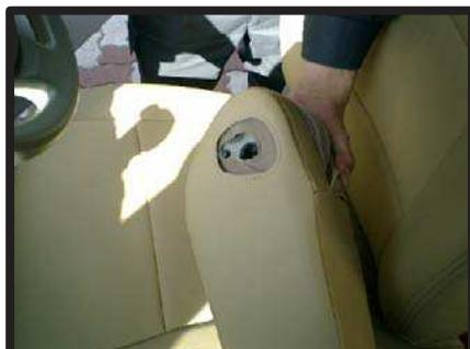
③②で引き下げたカバーを、アームレストの内側だけ先にかぶせます。
