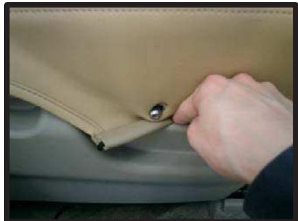
⑥カバーには、穴あけ加工をしていますので、穴の部分を①で取り外したシートリフター位置に合わせ、サイド側のカバーをプラスチックカバーの中に入れ込んでいきます。
