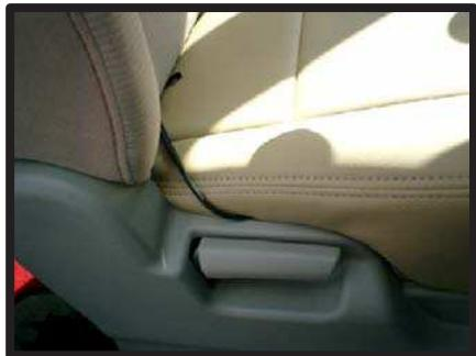
⑦カバー固定用のヒモを、サイドのプラスチックカバーに入れ込みながら、背もたれと座面の間に通していきます。
