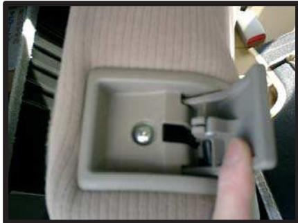
①初めに、肩口にあるリクライニング用ノブに付いているネジを、+ドライバーで外し緩めて下さい。
