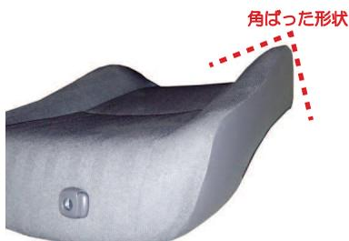
2 シートを上から見た状態です。通常、サイドエアバッグ展開部分はシート表面と側面の境界に位置し、一般的には角ばった形状をしています。サイドエアバッグ展開部分はその角の頂点に位置します。
