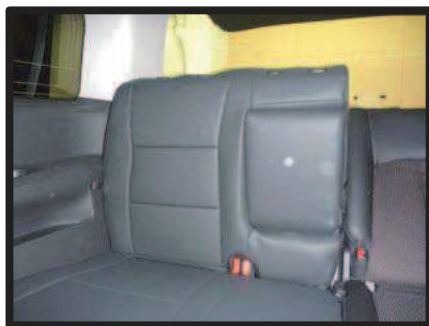
⑫ 14 ページの逆手順でアームレストを戻し、カバーのラインを整え、3 列目背もたれの完成です。 助手席側は一部形状が異なりますが、同様に取付けます。
