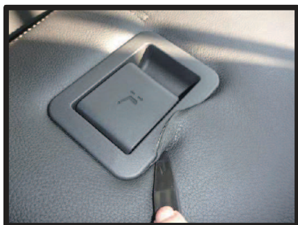
⑧ シート背面のシートスライド用レバー部に、ヘラ等を使用し、生地を入れ込みます。
