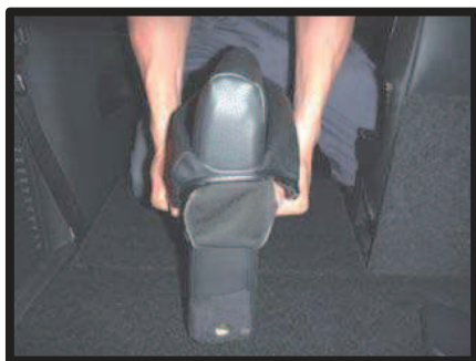
⑨ 14 ページで外したアームレストにカバーを半分程裏返し、ラインに合わせてカバーをかぶせます。
