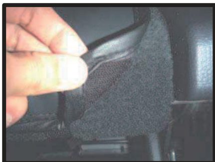
⑪6ページの図②で入れ込んだ生地の裏側に付いているマジックテープをシートに直接固定します。
