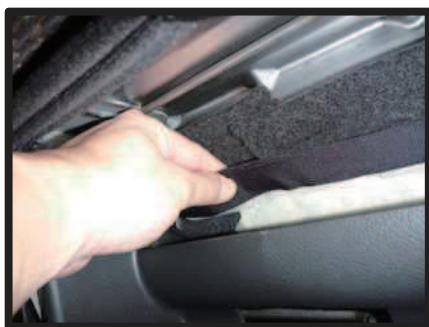
⑨マジックテープをアウトマン裏側で固定します。
