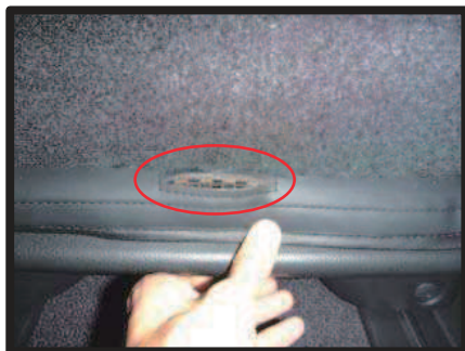
⑩6ページの図②で入れ込んだ生地を後ろ側から引き出します。 * 2列目座面には、図のような加工穴があり、チャイルドシートを固定するバーの位置に合わせます。
