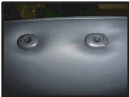
②ヘッドレストの台座部分をカバーの加工穴から取り出します。 取り出し方法は、4 ページ図⑤と同様です。
