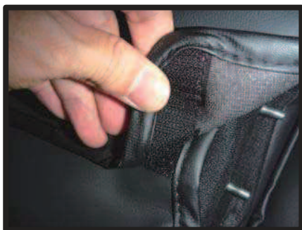
⑥アームレストの下パーツ部分はマジックテープで固定します。
