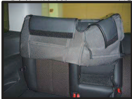
①カバーを図のように半分程裏返し、シートラインに合わせます。
