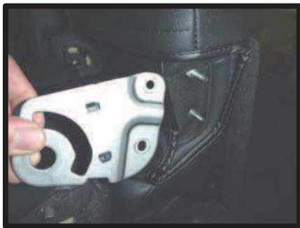
③図の金属部品を外します。
