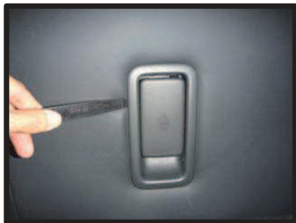
⑪ シート背面のシートスライド用レバー部に、ヘラ等を使用し、生地を入れ込みます。
