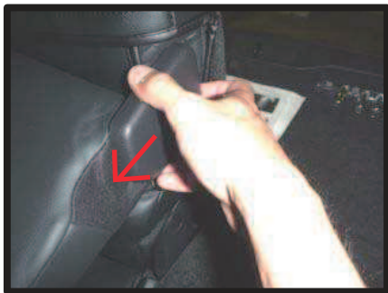
①図のプラスチック部をアームレストから矢印方向へスライドさせ、外します。
