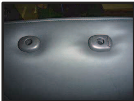
②ヘッドレストの台座部分をカバーの加工穴から取り出します。 取り出し方法は、3ページ図⑤と同様です。
