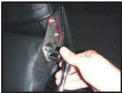
②ラチェットレンチ等を使用し、ナットを外します。 丸で囲んだナットも同様です。
