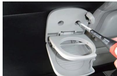
17 ネジをもう一度取り外し、カップホルダーとバックグリップを元に戻します。
