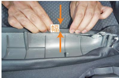
8 両側面部分は中に折り込むカバーの幅を左右均等になるようにして、カバーでアームレストをはさむようにして取り付けます。
