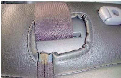
13 肩口シートベルトの付け根に付いているプラスチックは取り出しません。図のようにプラスチックカバーの上に生地が重なります。
