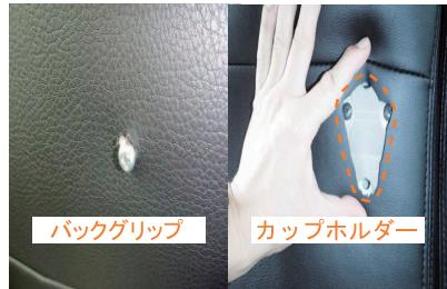
16 15番で付けた印の部分に切れ込みを入れネジを取り出す様に穴を開けます。カップホルダーは4つのネジを囲む様に穴を開けます。
