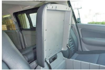
10 アームレストを元の位置に戻し、フタの裏側のネジを戻します。
