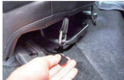
12 シートの前側からベルトを取り出す際はシートを一番後ろにスライドさせ引き出します。引き出したベルトとバックルはスライドレバーの上を通し固定します。
