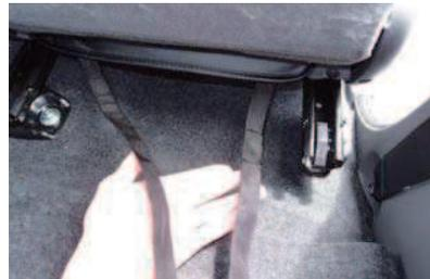
11 カバーの後ろ側に付いているベルトを座面の下を通し前方へ入れ込みます。ベルトを座面の下に通す際はシートを一番前にスライドさせ、座面の下に入れ込みます。
