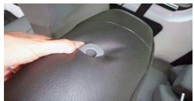
**9** ヘッドレストの台座を取り出します。カバーの加工穴から生地の伸びを利用して取り出します。
