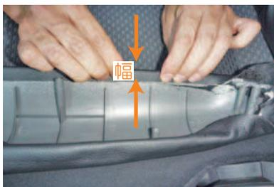
**8** 両側面部分には中に折り込むカバーの幅を左右均等になるようにして、カバーでアームレストをはさむようにして取り付けます。
