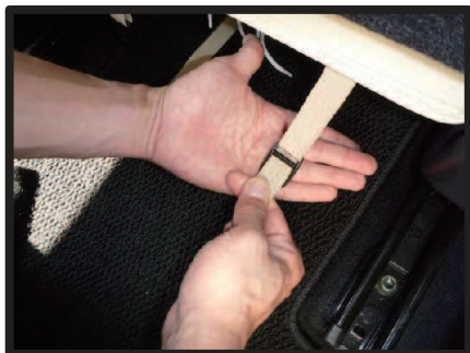
⑮引き出したベルトを1ページの④で引き出した生地についているバックルに通して固定します。
