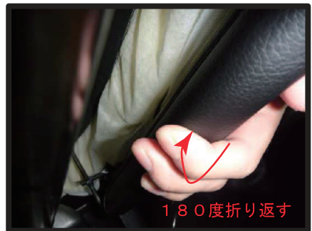
⑤④で確認したシート本体に固定されているブラックの上から、カバーのブラックを固定します。
