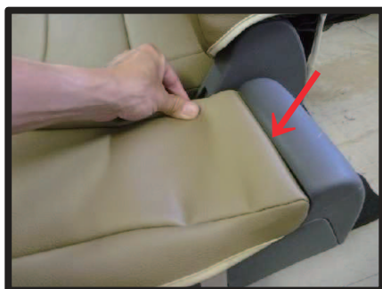
⑩ 1列目中央のアームレスト下のボックス部分です。始めに図の矢印部分にカバーを引っ掛けるようにかぶせます。
