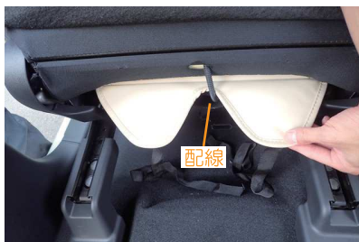
24 入れ込んだ生地を、背面側から引き出します。 配線が通っている場合、カバーのくぼみで配線をかかわすようにして下さい。
