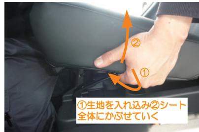
12 運転席側座面は、始めにシート内側面のシート裏の隙間に、マジックテープの付いた生地を入れ込み、シート全体にカバーをかぶせます。その他は一部形状は異なりますが、助手席側同様に取付けます。
