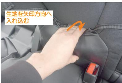
11 アームレスト下の隙間から生地を入れ込み中にあるくぼみに、生地の上に巻いてある部材を、はめ込むように固定します。
