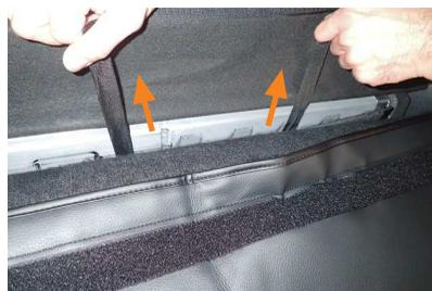
6 PHEVは2列目シート背面とラゲッジスペースの隙間が大変狭いため、生地の端に図の用なベルトを付けています。まずベルトを引き出し、ベルトを慎重に引っ張りながら生地の端がつかめるまで引き出します。生地の端がつかめたら生地を引っ張り引き出します。ベルトはあくまで生地を引き出すサポートの役割です。強く引っ張りすぎるとすぐに切れる恐れがありますので、ご注意ください。
