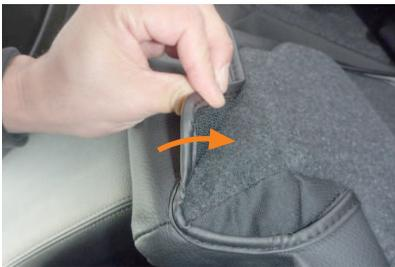
9 アームレストの下になるシート裏です。こちらでも直接シートにマジックテープを貼り付けて固定します。
