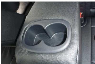
7 ドリンクホルダーのフチに生地を入れ込みます。隙間が大変狭いので、ヘラなどを使用して慎重に行ってください。
