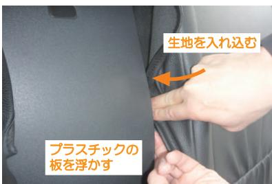
12 アームレストを倒して、アームレスト収納部に生地を入れ込みます。収納部にあるプラスチックの板を反るようにして少し浮かしながら、生地にシワがよらないように入れ込んでいきます。板を破損させないように作業は慎重に行ってください。
