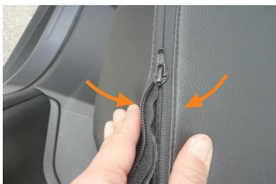
7 カバー外側面のファスナーを、生地を内へ寄せながら慎重に閉じます。カバーからはみ出したファスナー部分は、折り返してカバーの中へ入れ込みます。
