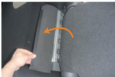
1 PHEVは背面下部のラゲッジルームと2列目シートの隙間を埋める為に、背もたれの背面下に生地が貼り付いています。シートカバーを装着する前に、こちらの生地を図のように外しておきます。
