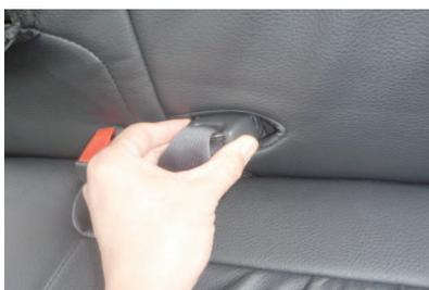
10 中央のシートベルトバックルは図のように収納します。
