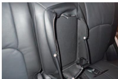
2 助手席側で説明しています。カバー外側面のファスナーを開けた状態にします。シートのラインに合わせてカバーをかぶせます。
