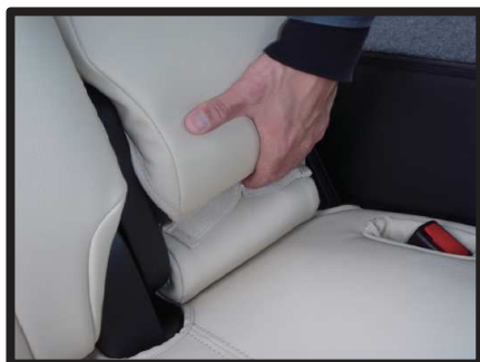
②アームレスト下に生地を入れ込みます。入れ込んだ生地をシート背面から引き出します。
