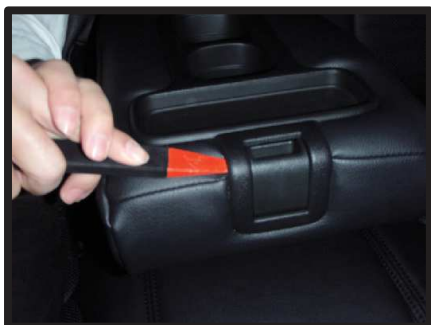
⑤レバー・ドリンクホルダーのプラスチック部分にヘラなどを使用し生地を入れ込みます。
