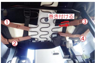
9 カバーの両側面に付いているマジックテープを、シート裏の金属部分に巻き付けるようにして固定します。
