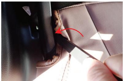
7 カバー外側のシート付け根付近の生地を、シートとプラスチックの軸の隙間に入れ込みます。
