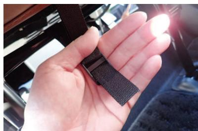
5 引き出したベルトを、カバー前側に付いているバックルに通し固定します。
