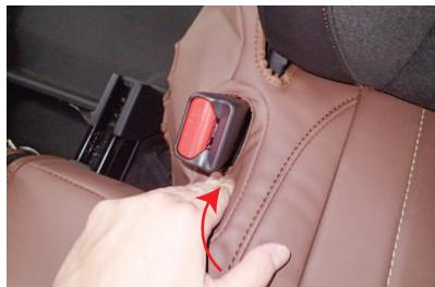
4 シートベルトバックル部にカバーの加工穴を通します。通した生地をしっかりと入れ込み、シートに馴染ませます。
