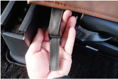
13 ⑨番で引き出した生地に付いているバックルに、ベルトを通し固定します。電動ウインチの影響で、シート下が狭くなっています。シートを一番後ろにスライドさせ、ベルトをバックルに通した後に、シートの前側からベルトを引くようにするとベルトが締めやすくなります。
