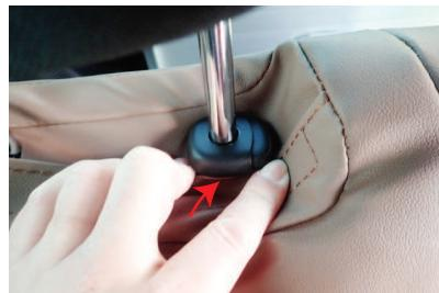
10 ヘッドレストの台座の隙間に生地を入れ込みます。
