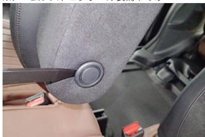
**14** 始めに、シートからアームレストを外します。アームレスト側面にあるキャップを、ヘラ等を使用し外します。
