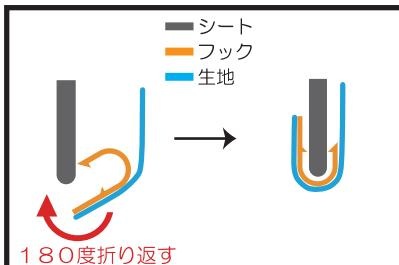
6 生地裏に付いているプラスチックフックを生地ごと巻き込むようにシートに引っ掛け固定します。
