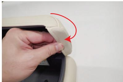
16 コンソールボックスのフタの先端に、カバーを引っ掛けようにかぶせます。
