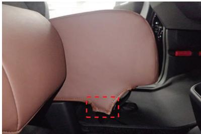
8 シート前側にも、図の赤線位置にプラスチックフックが付いているので、5番と同様に固定します。
