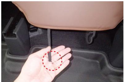
13 カバーの背面下に付いているゴムに、付属の金属フックを取り付けます。
