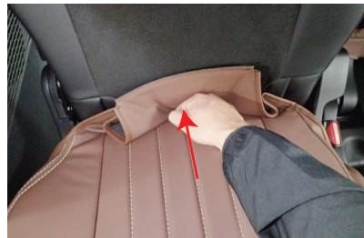
4 背もたれと座面の隙間に生地を入れ込みます。
