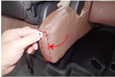
7 シート内側面後ろの角に、カバーに付いているマジックテープをシートに直接貼り付け固定します。
