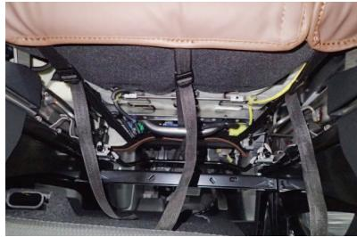
16 シート下を後ろ側から見たところです。シートを動かした際に、ベルトがシートに干渉していない事を確認してください。
