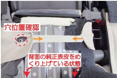
13 11番と12番で背面に通した生地に付いているマジックテープ同士を、背面の純正表皮をめぐり上げた状態で固定します。カバーに開いている加工穴と4番で外したピンの固定穴の位置が合っている事を確認して下さい。
