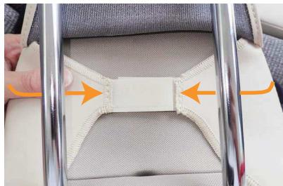
3 ヘッドレストをシートから外して、カバー裏に付いているマジックテープ同士を、ヘッドレストの裏で固定します。
