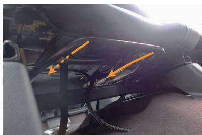
11 カバー前側に付いているベルトを、シートの裏側から、シートの背面側へ通します。
