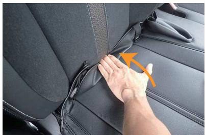
9 背もたれと座面の隙間に生地を入れ込みます。端にゴムが付いている生地も一緒にに入れ込みます。
