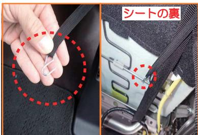
15 ⑩番で引き出した生地に付いているゴムに、付属の金属フックを取り付けます。金属フックは、シート裏の金属部分に引っ掛けで固定します。
