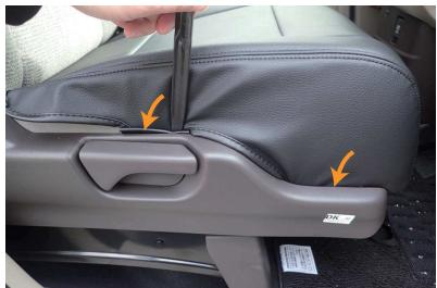
7 ハイトアジャスター未装備車の外側面です。生地を図の矢印位置にある固定具と一緒にプラスチックカバーとシートの隙間に入れ込みます。
