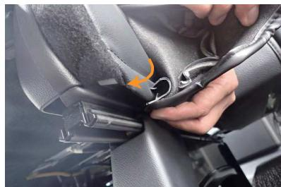
6 カバー内側面の生地に付いているプラスチックフックをシートのフチに固定します。
