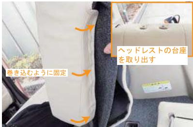
**10** カバーの加工穴からヘッドレストの台座を取り出し、カバー内側面のマジックテープが付いた生地を、シートを巻き込むようにして、シート裏（シートと背面のボードの隙間）に直接貼り付けて固定します。
