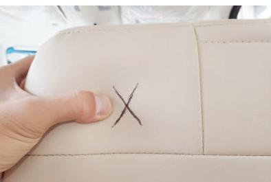
15 コンビニフックを使用されるお客様は、コンビニフックを取り外して穴が開いている部分を指で確認しながら、カバーに印を付けます。
