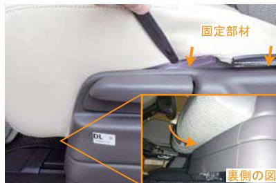
5 カバー前面裏側の生地と外側面に付いている固定部材（2箇所）をプラスチックカバーと一緒にシートの隙間に入れ込みます。
