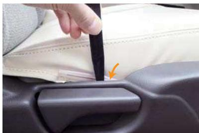
7 外側面の生地に付いている固定部材を、ヘラ等を使用し、プラスチックカバーとシートの隙間に入れ込みます。
