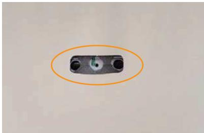
10 カバーの加工穴と、15ページ1番で外したプラスチックパーツの穴位置が合っている事を確認し、プラスチックパーツを元に戻します。
