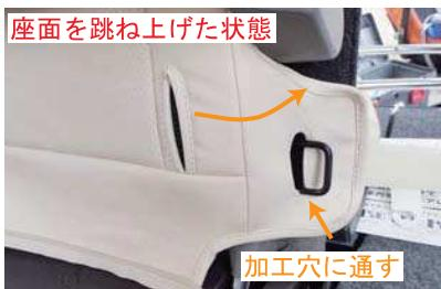
**12** 内側の生地も同様に背面側に回します。この時、18ページ5番で純正表皮が固定されていた金属部分を、カバーの加工穴に通して下さい。
