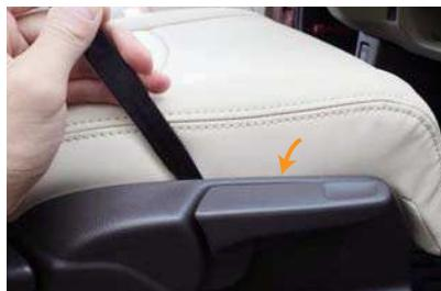
6 外側面の生地をヘラ等を使用し、プラスチックカバーとシートの隙間に入れ込みます。
