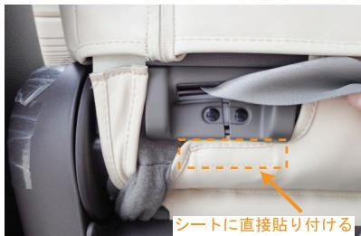
9 純正表皮を避けた左端のマジックテープも8番と同様に固定し、シートベルトが出ている部分の下側はカバー裏側に付いているマジックテープを、直接シートに貼り付けて固定します。
