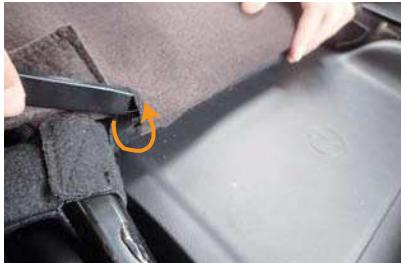
1 始めに、シート背面下部の純正表皮を固定しているプラスチックフックの固定を外します。
