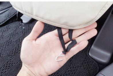
13 カバー背面下部の生地に付いているゴムに付属の金属フックを取り付けます。
