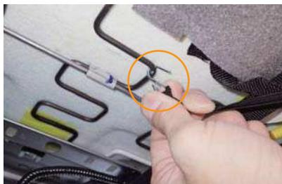
17 取り付けた金属フックを、シート裏の金属部分に引っ掛け固定します。
