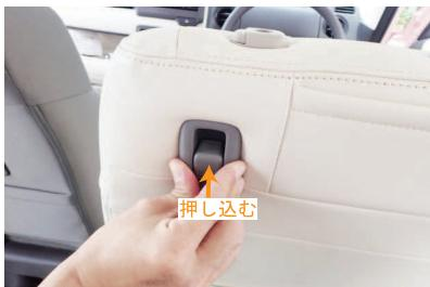
17 フレームに開いている穴に、ツメを差し込み、フックを強く押す事で元に戻すことができます。
