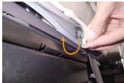
11 カバー内側面の生地に付いているプラスチックフックをシートのフチ（純正のプラスチックフックが付いている部分）に固定します。詳しい固定方法は12番を参照して下さい。
