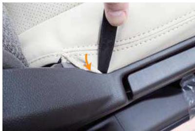
8 外側面の後ろ側の生地を、プラスチックカバーとシートの隙間に入れ込みます。
