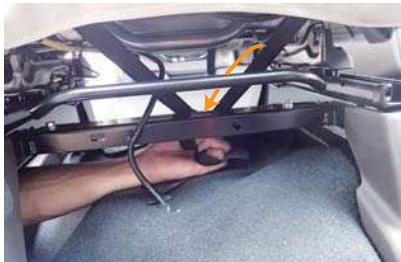
13 カバー前側に付いているベルトをシートの裏を通して背面側に回します。
