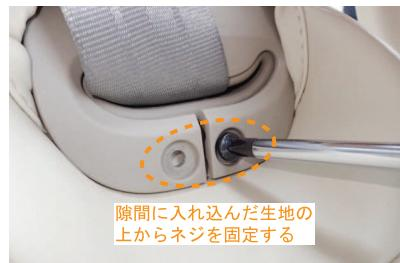
11 13ページ1番で外したネジを、生地の上から直接固定し戻します。
