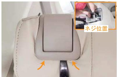
17 肩口のレバーとシートの隙間に生地を入れ込みます。隙間がかなり狭い為、ドライバーを使用し、レバーの固定を緩めると作業が行いやすくなります。レバーを上げた箇所にネジで固定されています。
