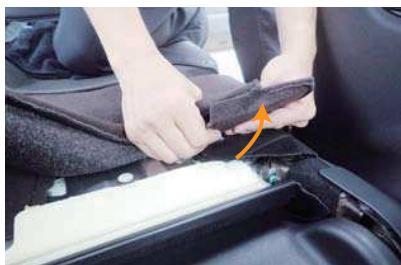
3 純正表皮がシートのフレームにピンで固定されている為、ピンを真上に引き抜き固定を外します。
