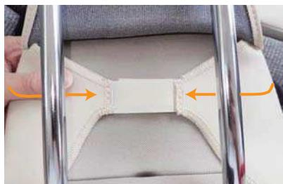
3 ヘッドレストをシートから外し、カバー裏に付いているマジックテープ同士をヘッドレスト裏で固定します。
