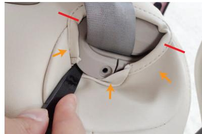
10 肩口のプラスチックとシートの隙間に生地を入れ込みます。図の赤線が入り込む範囲です。
