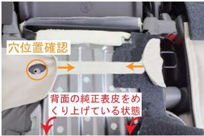
13 11番と12番で背面に回した生地に付いているマジックテープ同士を、背面の純正表皮をめくり上げた箇所で固定します。カバーに開いている加工穴と4番で外したピンの固定穴が合っている事を確認して下さい。
