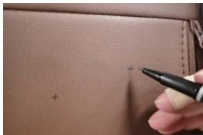
6 カバーの上から、ボルトと突起物が刺さる穴位置に穴開け加工用の目印を付けます。（計8ヶ所）
