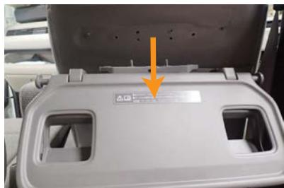
4 ボルトを外し、テーブルを手前に引くようになるとシートからテーブルが外せます。※外したテーブルは傷つけないよう、注意して下さい。
