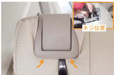
17 肩口のレバーとシートの隙間に生地を入れ込みます。隙間がかなり狭い為、レバーを上げるとネジが見えますので、ドライバーを使用し、ネジを緩めると作業が行いやすくなります。
