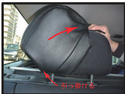
⑦ 2列目ヘッドレストは、カバーを側面に引っ掛けるようにし、生地伸びを利用してかぶせます。
