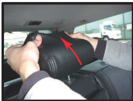
⑨ 2列目中央ヘッドレストは、カバーを前側に引っ掛けるようにしながらかぶせます。固定方法は、同様になります。
