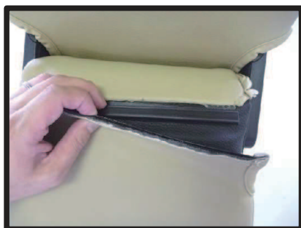
⑫入れ込んだ生地を引き出し、図のように生地同士をブラックで固定します。
