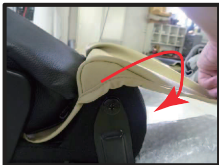
⑦入れ込んだ生地を、図のように包み込むようにかぶせ、裏側へ巻き込みます。
