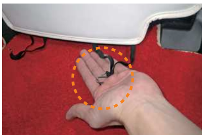
14 カバー背面下の生地に付いているゴムに付属の金属フックを取り付けます。
