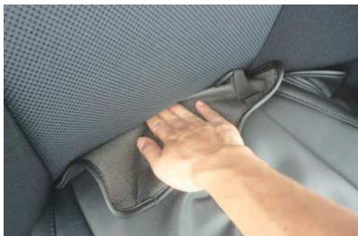
2 背もたれと座面の隙間に生地を入れ込みます。背もたれの角度を調整して入れ込みやすい角度で行って下さい。
