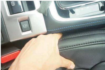
7 カバー内側面の生地に付いているマジックテープをシートに直接貼り付けます。
