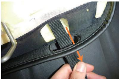
8 10ページ6番で通したベルトをシート背面から引き出して、カバーの加工穴に通します。
