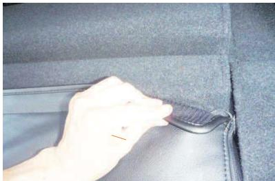
15 カバー背面下のマジックテープをシートに直接固定します。
