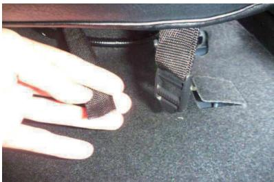
8 カバー前側に付いているベルトを座面裏を通して背面側へ引き出して固定します。
