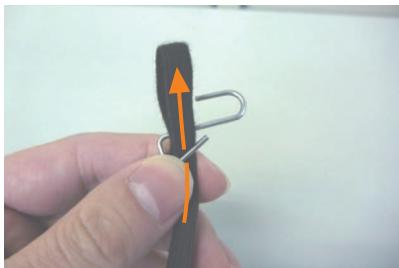
1 ゴムと金属フックの取り付け方は、始めに図のように金属フックにゴムを通します。
