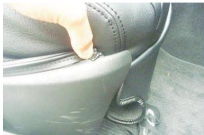
4 カバー外側面の生地をシートの隙間に入れ込みます。
