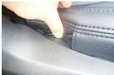
5 カバー外側面後ろ側の生地をシートの隙間に入れ込みます。
