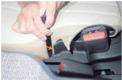
15 付属のヘラ等を使用し、カバー内側面の生地をプラスチックの隙間に入れ込みます。
