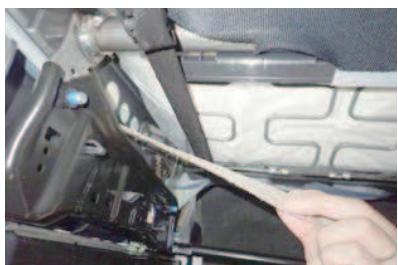
15 入れ込んだマジックテープのベルトを、座面の裏側から引き出します。
