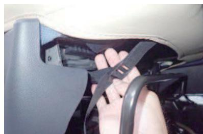
12 前側に通したベルトと、カバー前側に付いているバックルを固定します。
