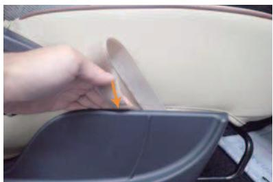
14 カバー外側面に付いているマジックテープのベルトをプラスチックカバーの内側に入れ込みます。
