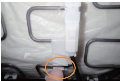
2 座面裏の金属部分に固定されているカプラーを外します。
