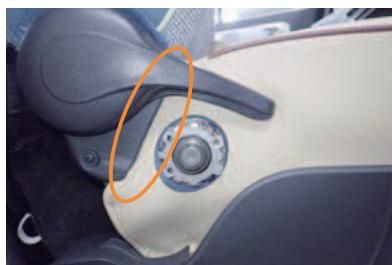
18 板状のプラスチックがプラスチックカバーに引っ掛けっていないと、固定が外れる恐れがありますので、しっかりと引っ掛けている事を確認して下さい。
