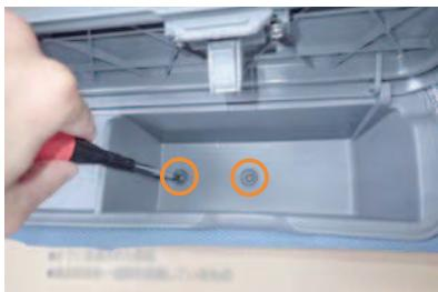
1 始めにドライバーを使用し、ボックス内の2箇所のネジの固定を外し、ボックスを本体から取り外します
