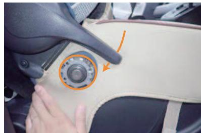
10 外側面の生地をリクライニングレバーの下に通し、シートリフター部分と生地の加工穴の位置を合わせます。
