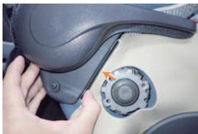
17 外側面の後ろ側に付いている板状のプラスチックを、プラスチックカバーの隙間に入れ込みます。
