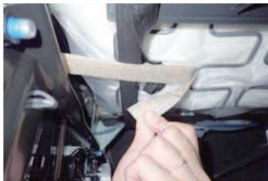
16 マジックテープのベルトを座面裏の金属部分に巻き付けて固定します。
