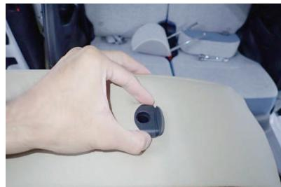
10 生地の伸びを利用して、カバーの加工穴からヘッドレストの台座を取り出します。
