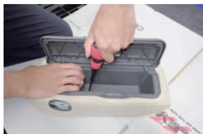
6 ボックスを下へ押し込みながら、1番で外したネジを元に戻します。
