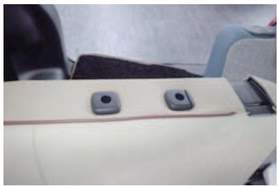
7 生地の伸びを利用して、カバーの加工穴からヘッドレストの台座を取り出します。
