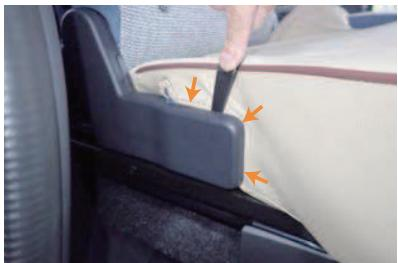
14 付属のヘラ等を使用し、カバー外側面の生地をプラスチックの隙間に入れ込みます。
