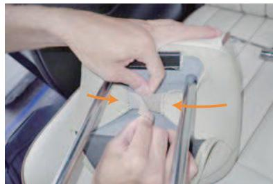
10 ヘッドレストを背もたれから取り外し、カバーの左右に付いているマジックテープをヘッドレスト裏で固定します。
