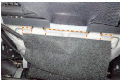
1 運転席と同様に、背もたれ背面から座面裏に回っている生地に付いている、3箇所のプラフックの固定を外します。
