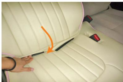
5 背もたれと座面の隙間に生地とカバーに付いているプラフックを入れ込みます。背もたれを一番後ろまで倒して行うと作業しやすくなります。
