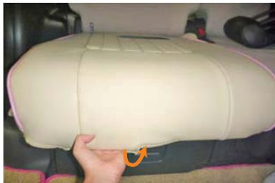
7 カバーの生地ごと内に巻き込みながら、シート本体に引っ掛けで固定します。この時シートの骨組みにプラフックがはまり込む音がするまで、しっかりとめ込んで下さい。
