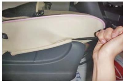
10 カバーの生地をシートとプラスチックの隙間に入れ込みます。
