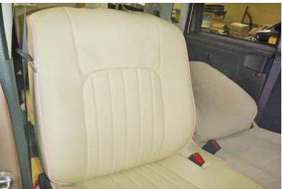
**13** サイドエアバッグ装備車は、サイドエアバッグの展開部分とシートカバーのSAB対応の縫い目部分が合っていることを確認してください。
