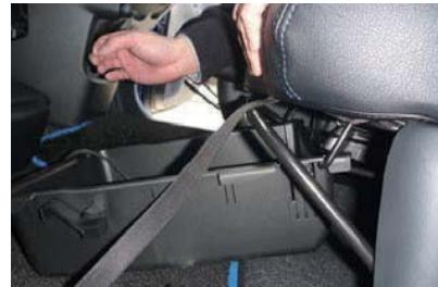
**17** 助手席側も一部形状が異なりますが運転席側と同様に取り付けます。カバー装着の前にシート底面のトレーを取り外してから作業を行って下さい。
