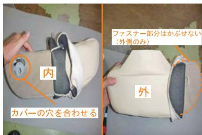
12 アームレスト本体にカバーを装着します。カバーに穴が開いている方が本体の内側、穴が開いていない方が外側です。カバーを半分に折り返し先端からかぶせます。図の様に外側のファスナー部分はかぶせないで下さい。
