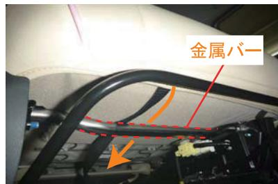
12 カバーの前側のベルトをシートの後ろ側に通します。この際、ベルトはシート底の金属バーの上を通して下さい。
