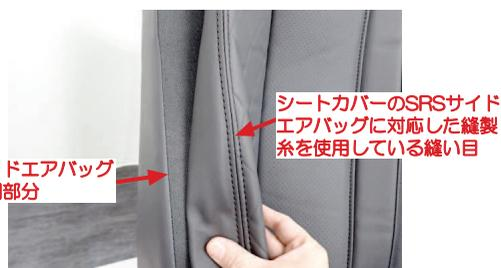
3 サイドエアバッグの展開部分と、シートカバーのSRSサイドエアバッグに対応した縫製系を使用している縫い目の位置（以降SAB対応の縫い目部分）を合わせます。※シートのサイドエアバッグ展開部分にはシートカバーの縫い目が必ず存在します。その縫い目はSRSサイドエアバッグに対応した縫製系を使用しています。
