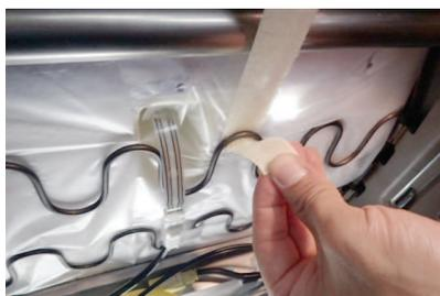
20 マジックテープのベルトをシート裏の金属部分に巻き付けて固定します。
