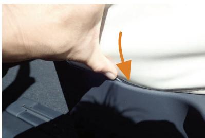
9 カバー外側の固定部材の付いた生地を、生地と一緒にプラスチックパーツの隙間に入れ込み固定します。
