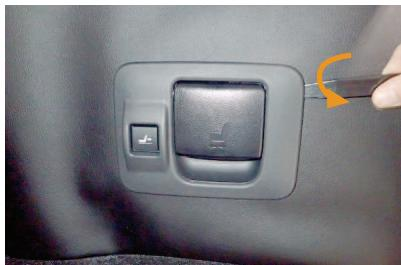
7 シート背面のスライドレバーを囲っているプラスチックパーツを取り外します。
