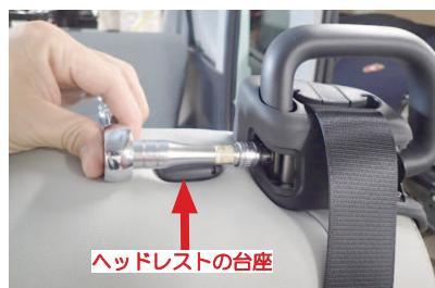
35 内側のボルトを外す際は、ヘッドレストの台座を傷付けないように注意して下さい。
