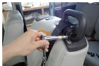
34 2カ所あるのプラスチックキャップを外すと、中にボルトがあります。ボルトをソケットレンチなどを使用して外します。
