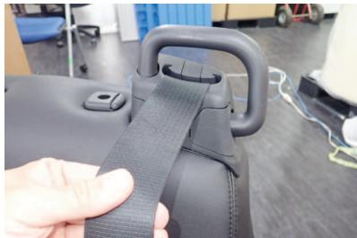
45 プラスチックパーツを元通りに固定して、再度シートベルトが正常に巻き取りされるか確認して下さい。
