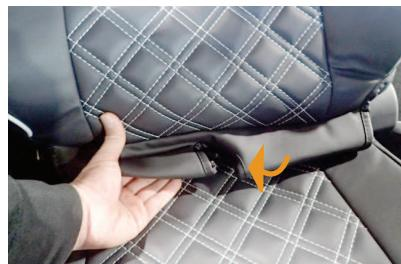
12 背もたれと座面の隙間に生地を入れ込みます。入れ込む生地にはフックが付いています。フックでカバーを傷付けないように、注意して下さい。
