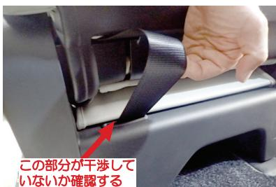
29 始めにシート背面のシートベルトが出ている部分を確認します。
