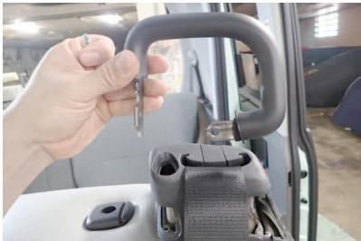
36 2か所ともボルトを外すと、まずシートを可動させる際に挿むアーム部分が図のように外れます。
