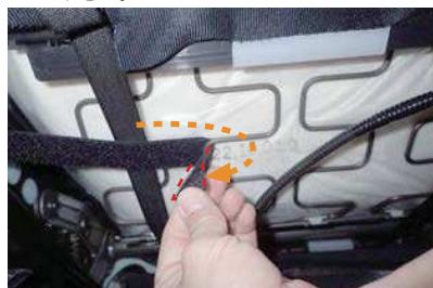
29 マジックテープのベルトをシート裏の金属フレームに巻き付けて折り返します。先端のオスのマジックテープをメスのマジックテープに貼り付けて固定します。
