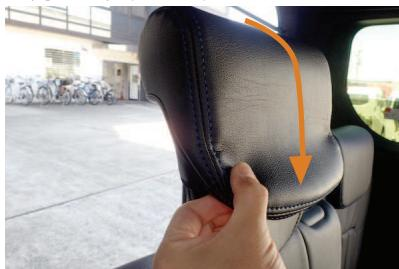
8 2列目ヘッドレストは2種類あり、2種類のシートカバーを同梱しています。ファブリックシートはカバーのタグに20HRと印字しているものを、ソフトレザー調シートは20HR中央と印字しているカバーを使用して下さい。
