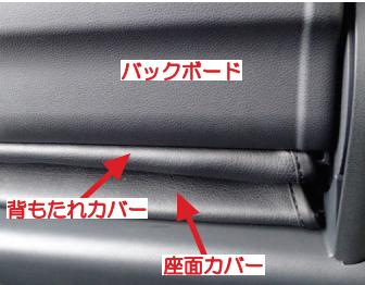
21 固定部材を全て入れ込み生地を固定出来れば、バックボードの表面側は図のようになります。
