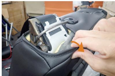
39 生地が白いプラスチックパーツに干渉している場合は、図のように生地を引っ張り、白いプラスチックパーツに干渉しない位置に調整します。
