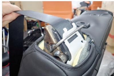
40 シートベルトの巻き取りが正常に作動していることを確認して下さい。
