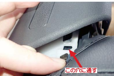
43 プラスチックパーツのツメを、白いプラスチックパーツの穴に必ず通して元に戻して下さい。
