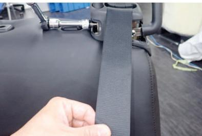
44 プラスチックパーツを完全に固定する前にシートベルトが正常に巻き取りされるか確認して下さい。
