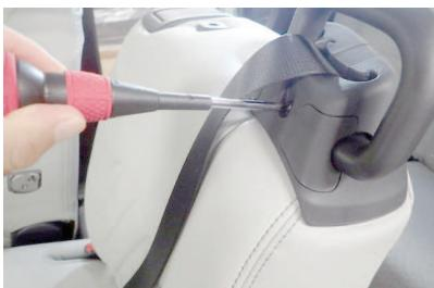
32 シートベルト台座部分のプラスチックパネルを外して確認します。
