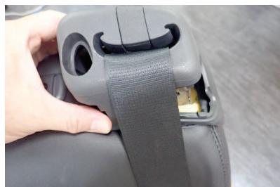
27P▶41 シートベルトが正常に巻き取りできるようになれば、プラスチックパーツを元に戻します。
