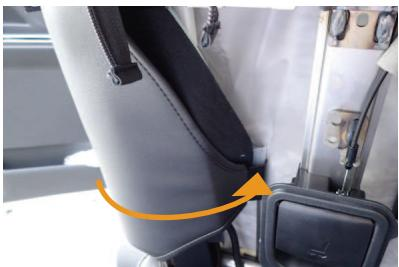
15 反対側の側面も同様です。純正シート地を固定しているフックの上から、カバーのフックを引っ掛けで固定します。
